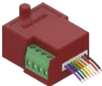
Le Module d'Entrée Universelle est un produit utilisé dans les systèmes domotiques. Il prend en charge diverses entrées et sorties et peut contrôler des dispositifs tels que des rideaux et des stores avec des capteurs de vent, de pluie et d'humidité. Il dispose d'entrées analogiques de 0 à 15V et de 4 à 20mA, d'entrées numériques, d'une entrée de capteur de température et d'une sortie externe de 12V. Il peut s'intégrer avec d'autres dispositifs domotiques via communication RF.
