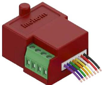
Universal Input Module, akıllı ev sistemlerinde kullanılan bir üründür. Çeşitli giriş ve çıkışları destekler ve perde, panjur gibi cihazları rüzgar, yağmur ve nem sensörleriyle birlikte kontrol edebilir. 0-15V ve 4-20mA analog girişler, dijital girişler, sıcaklık sensörü girişi ve harici 12V çıkışı bulunmaktadır. RF iletişimini sayesinde diğer akıllı ev cihazlarıyla entegre çalışabilir.
